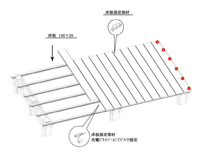
⑤床板(145×25)を付属床板固定部材を根太にビスにて固定し片側から差込ます。
